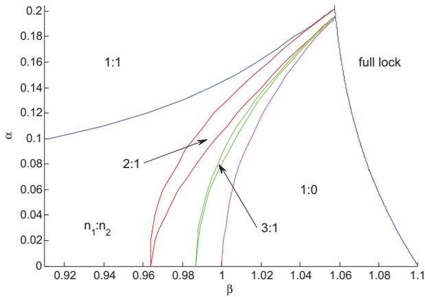
Fig. 7.  $\Omega_2 = 1.1$ ; NUMERICAL  $N : 1$  FINDINGS AND DRIFT/LOCK BIFURCATION CURVE.
